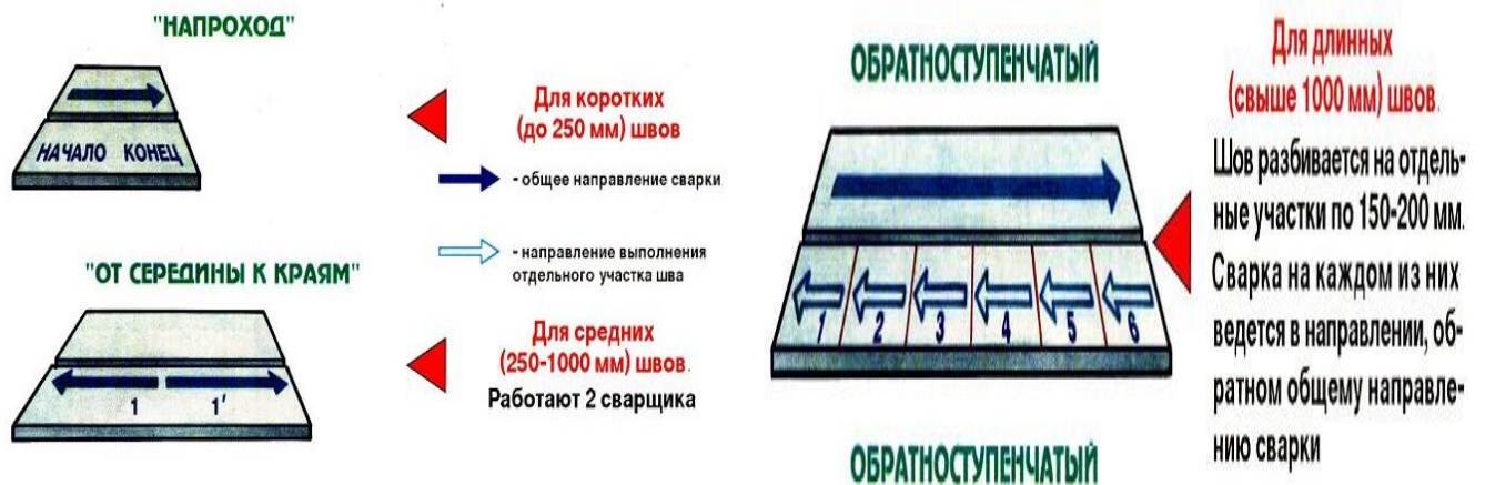
Рисунок 2 – Последовательность выполнения сварных швов
